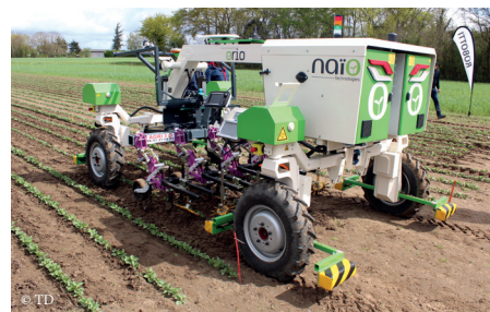
Le robot Orio de Naïo a été conçu pour une utilisation en légumes de plein champ.
