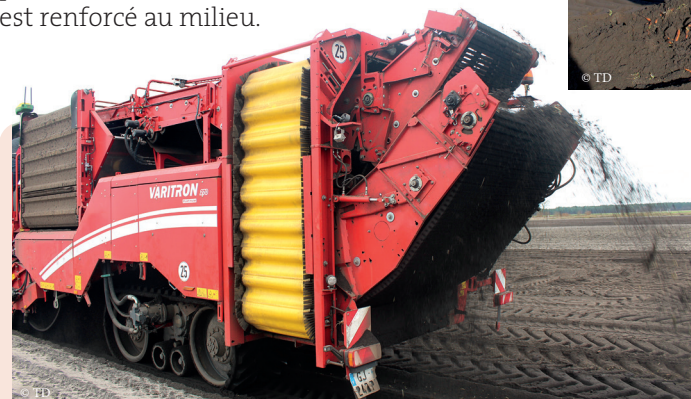
La Varitron avec le tapis à tétines rallongé de 50 cm.
