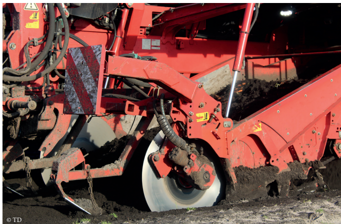
Les Varitron ont été équipées de disque de 800 mm pour la récolte des carottes labourées.
