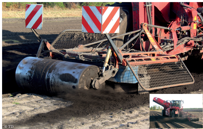
Positionnées en lieu et place de l'outil de défanage, les turbines de la débuteuse permettent de retirer les premiers centimètres de sable sans endommager les carottes.
