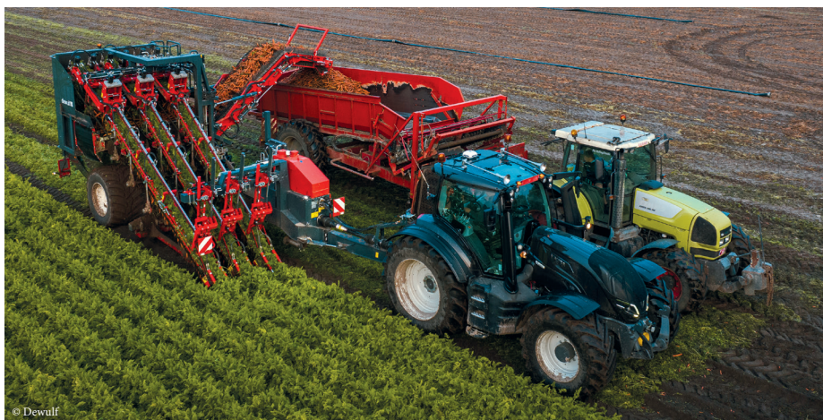
Dewulf propose une arracheuse traînée trois rangs avec une largeur de 3 mètres une fois le convoyeur replié pour les trajets sur route.
