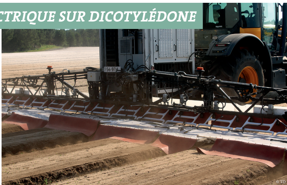
En temps normal, le Nucrop effectue le désherbage avec une herse étrille et non des panneaux. Malheureusement ce matériel n'était pas disponible pour la démonstration.
