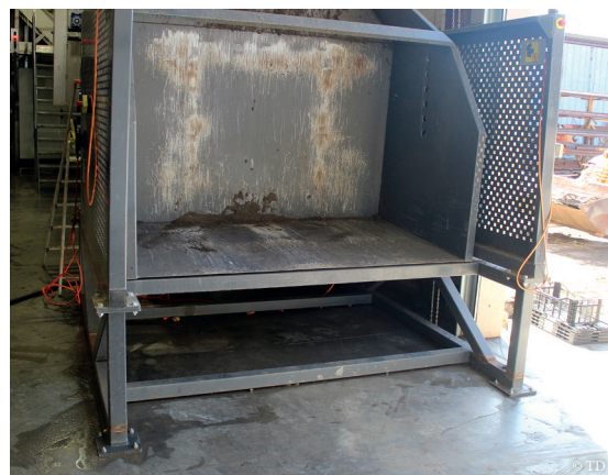
Les pieds du vide palox ont été coupés et ressoudés pour s'adapter à la nouvelle installation.
