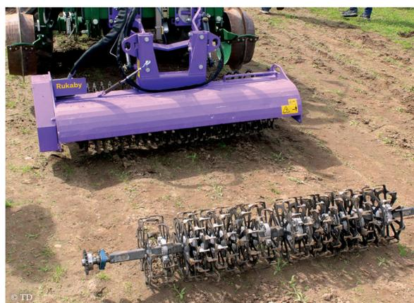
L'outil Rukaby permet d'interchanger rapidement les jeux de disques pour éviter de régler l'ensemble en passant d'une culture à l'autre. →
