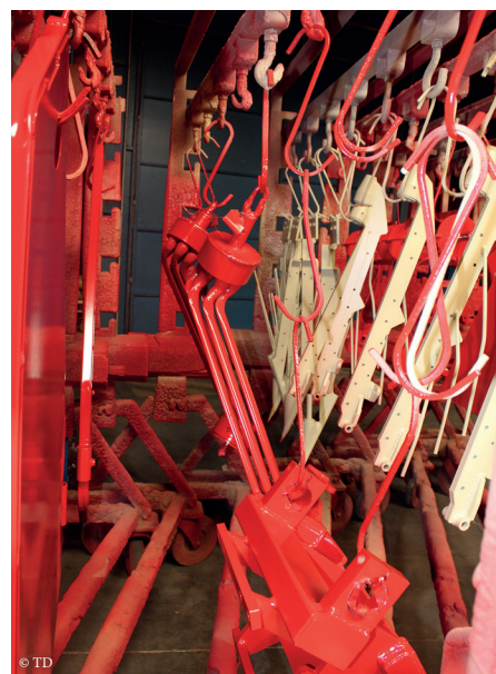
Selon les pièces, elles sont assemblées ou non avant de passer en chambre de peinture. Ici, les barreaux d'équeurs aux couleurs Simon.
