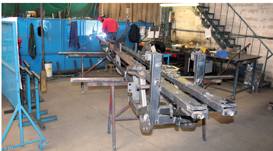
Les différentes pièces passent ensuite dans les ateliers de soudure à l'image de ce cueilleur carotte.
