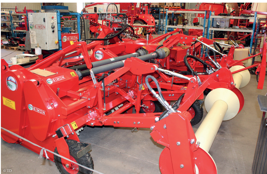
À l'image, un Cultirateur destiné à préparer des planches de carotte en phase d'assemblage final.
