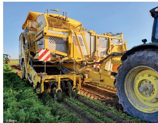
Sur la Ropa Keiler 2, le bâti arracheur à socs de pommes de terre peut être remplacé par une version à fourches plus adaptée aux carottes en une dizaine de minutes.
