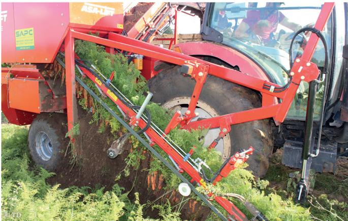
La vitesse d'avance et d'inversement des courroies se règle en cabine pour gagner du temps.
